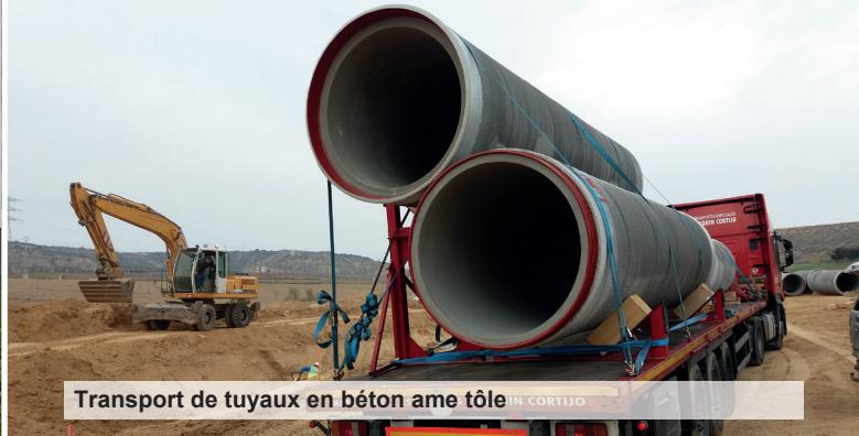
Transport de tuyaux en béton ame tôle IN CORTIJO
