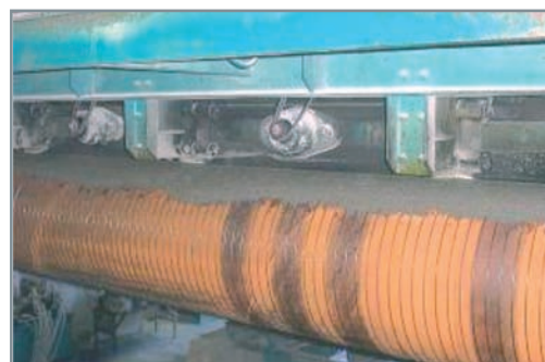
■ Regla vibrante para revestido del núcleo.
