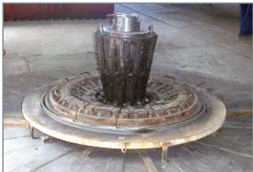
■ Expansionado para conformar cabezales.
