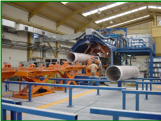
**Fabricación de tubería de PRFV
