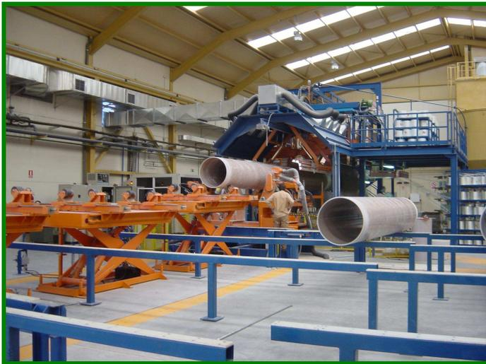
**Fabricación de tubería de PRFV
