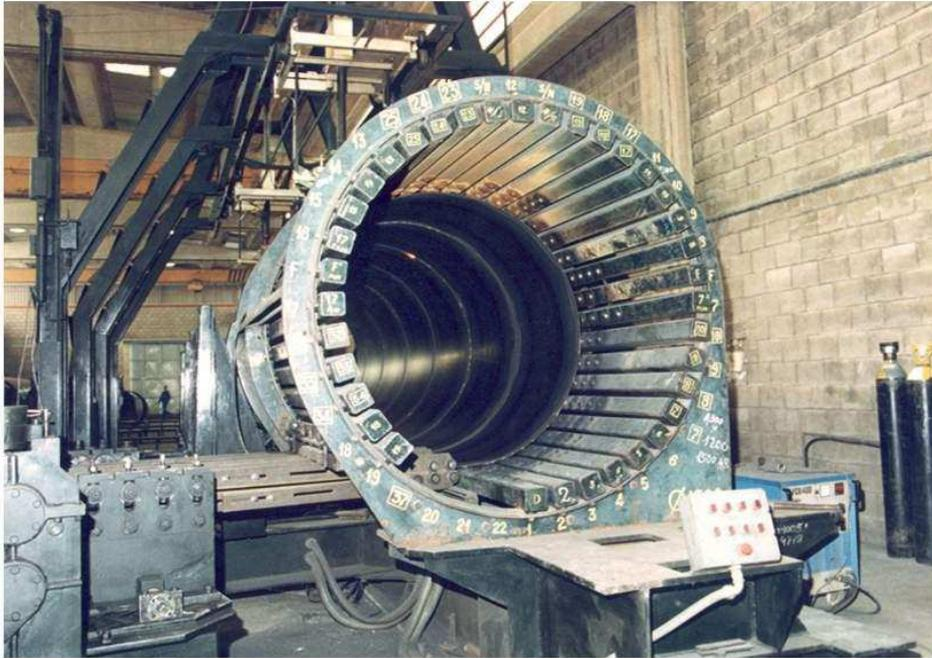
**Fabricación de camisa con soldadura helicoidal.**
