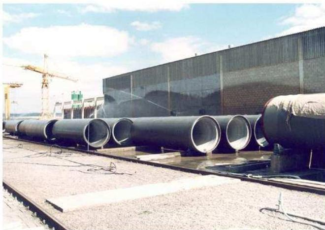
**Curado del revestimiento mediante riego por aspersión.**
