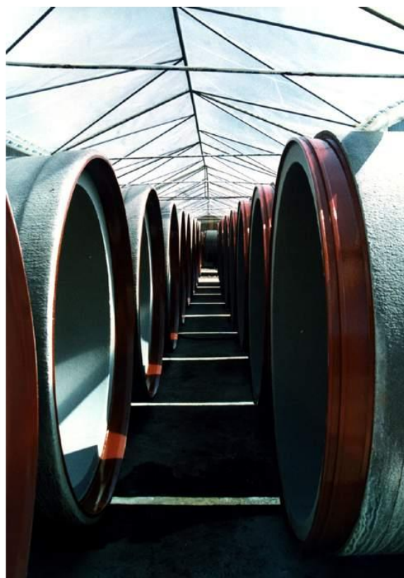
Tubería de Hormigón Postesado con camisa de chapa y junta elástica (Cabezales macho y hembra)
