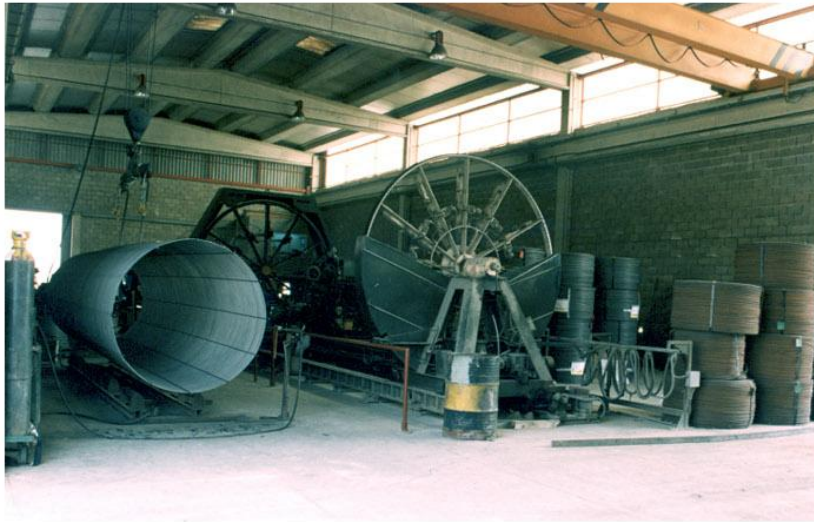
Fabricación de jaula de armadura de acero corrugado
