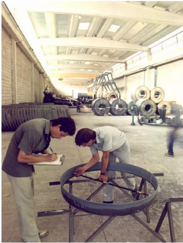
Control dimensional cabezal expandido
