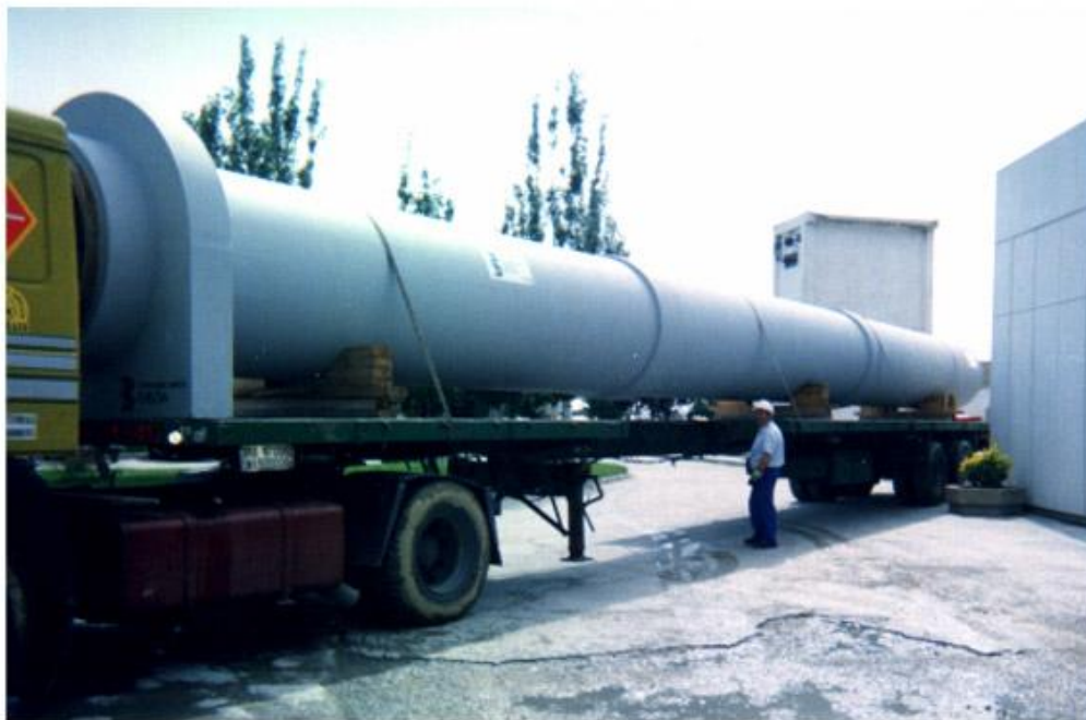
Tubería autoportante de diámetro 1200 mm. y 18 m. de luz
