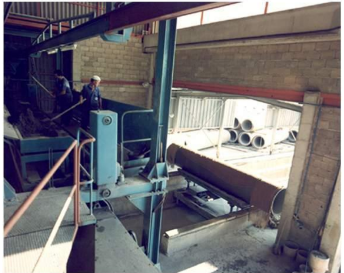
Salida del tubo revestido a zona de curado
