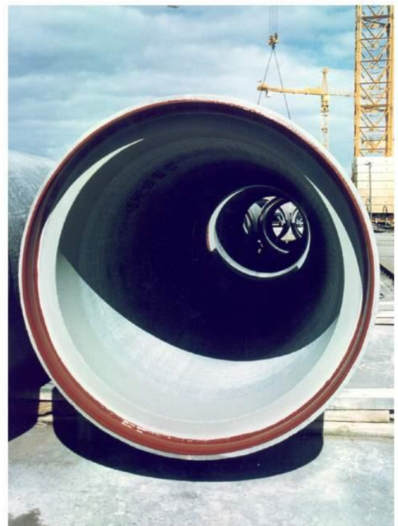
Tubo de Hormigón Postesado con camisa de chapa y Junta elástica, terminado.
