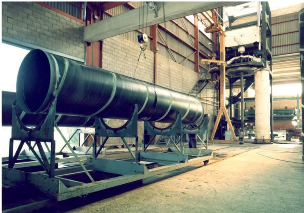
Prueba de estanqueidad de la camisa
