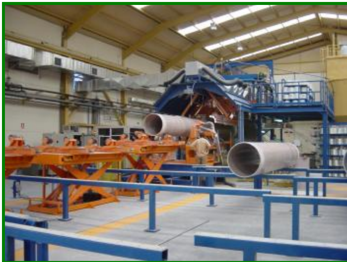
Fabricación de tubería de PRFV Sistema de mandril continuo
